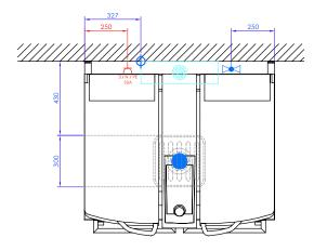
Die Wandrinne muss mit einem Gefälle von 1% in Richtung des fest Wand- oder Bodenablaufflussesmontiert werden!!
